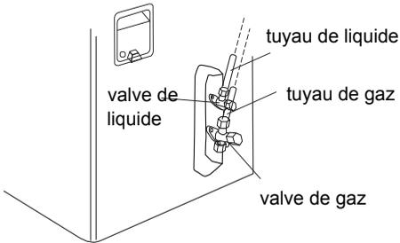
3. Pré-serrer l'écrou de raccordement à la main.
