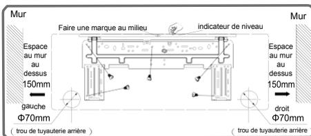
2. Ouvrir un trou de tuyauterie avec le diamètre de  $\Phi 55$  ou  $\Phi 70$  sur la position sélectionnée du tuyau de sortie. Pour drainer facilement, incliner légèrement le trou sur le mur en descendant sur le côté extérieur avec une pente de 5-10°.
