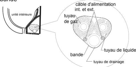
2. Réserver une certaine longueur de tuyau de drainage et de cordon d'alimentation pour l'installation lors de leur liaison. En les liant à un certain degré, séparer l'alimentation intérieure et ensuite séparer le tuyau de drainage.
