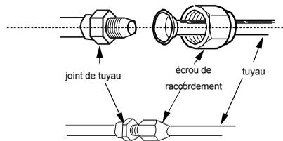
3. Ajuster la force de couple en vous référant à la page suivante. Placer la clé plate sur le joint du tuyau et la clé dynamométrique sur l'écrou de raccordement. Serrer l'écrou de raccordement avec la clé dynamométrique.
