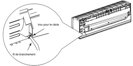
3. Retirer la pince du fil; brancher le fil de branchement au terminal de branchement selon les couleurs, serrer les vis et fixer le fil de branchement avec la pince du fil.
