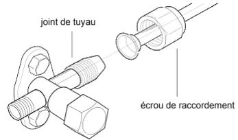
4. Serrer l'écrou de raccordement avec la clé dynamométrique en vous référant à la feuille plus bas.
