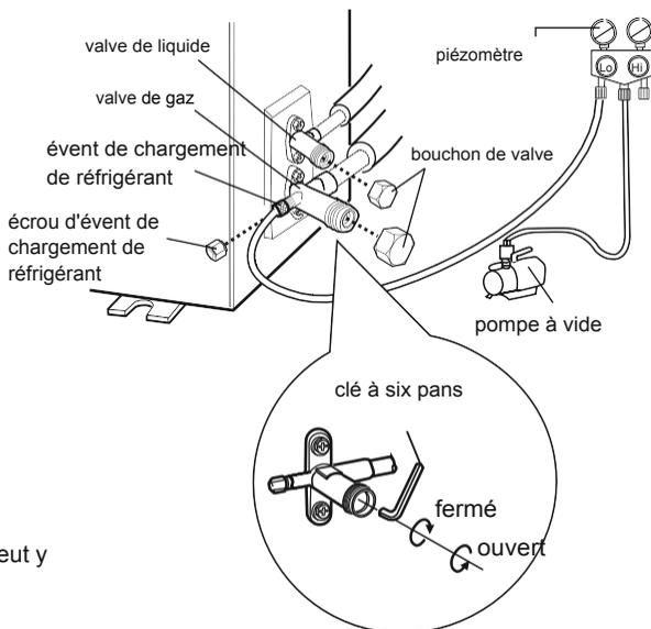
5. Retirer le piézomètre, ouvrir la vanne de la valve de liquide et valve de gaz complètement avec la clé hexagonale.
